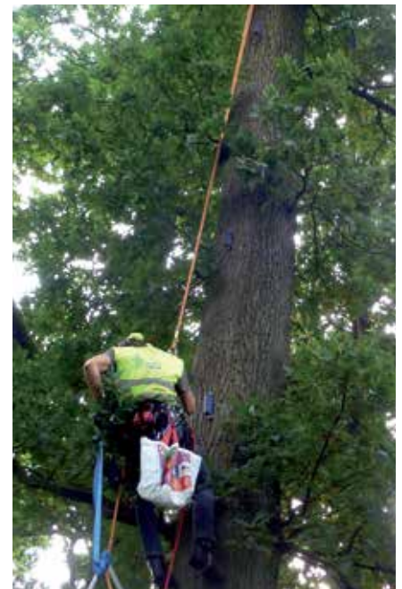
Plaatsing van elastometers (trekproef)
